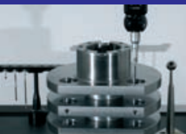
3D-Koordinatenmessung im klimatisierten Raum
