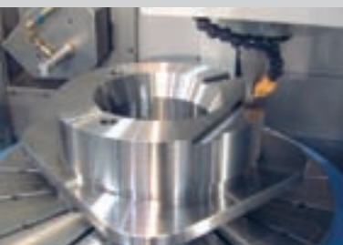
Schleifen einer außermittigen Führungsnut
