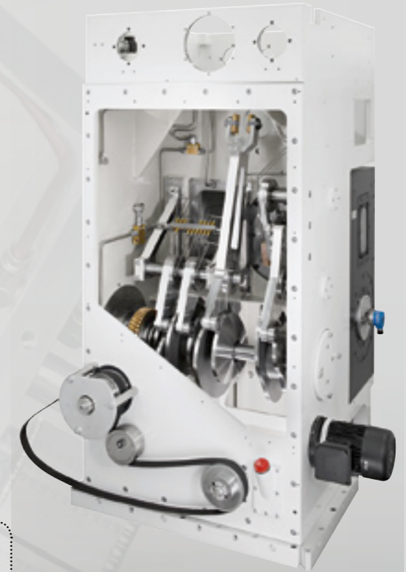
MONTAGEAUTOMAT kurvengesteuerte Bewegungsabläufe in Verpackungsmaschinen
